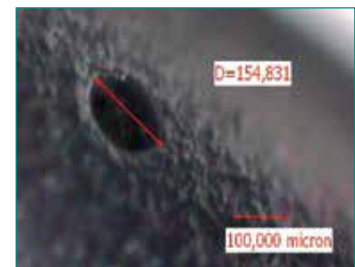
Misure fori di nebulizzazione. Measures for atomising holes.
